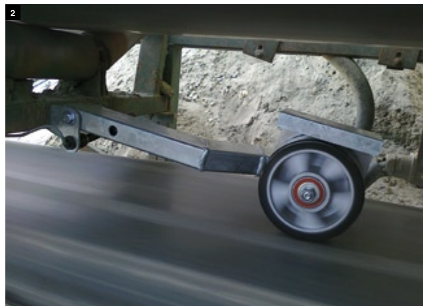
2. C-Weigh szalagmérleg robusztus sebességmérő kereke.
