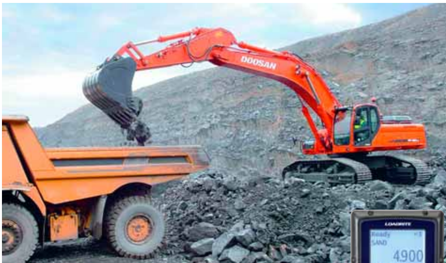
Robustes System: Mit der hydraulischen und dynamischen Baggerwaage X-Weight wiegen Nutzer ab sofort ohne Wägezellentechnik.
